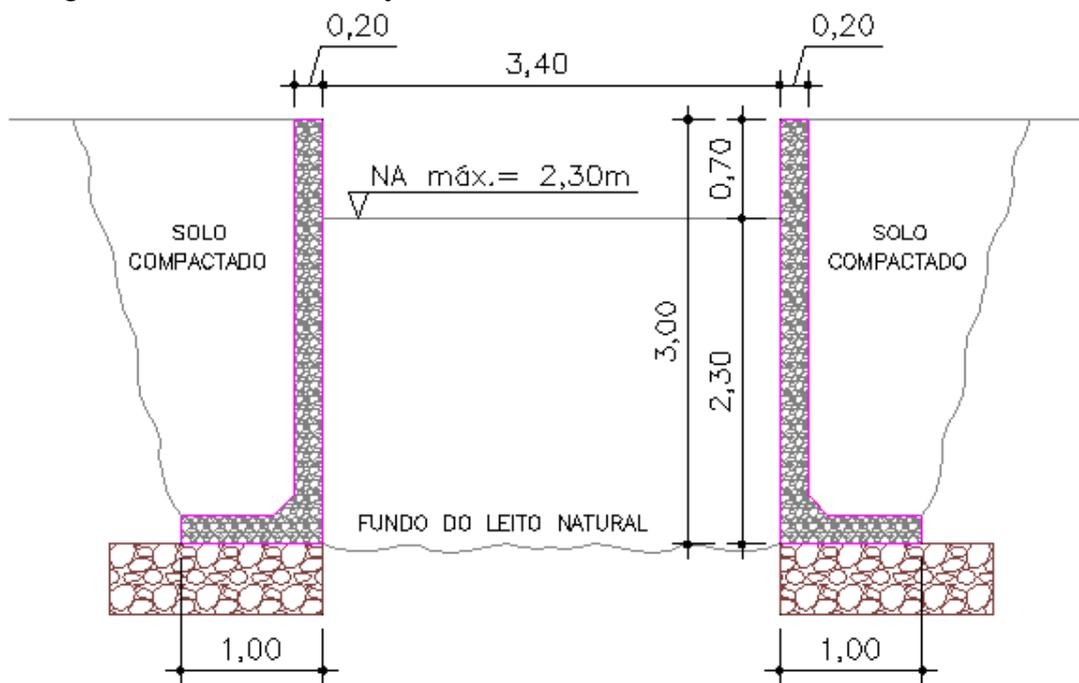
Imagem96. Dimensões da secção do canal
